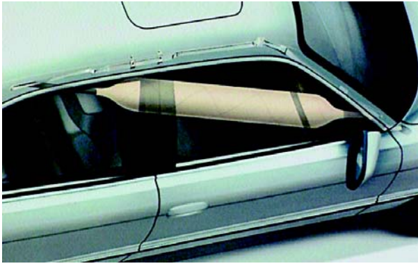
ITS nicht ausgelöst (im Dachbereich) und ausgelöst
