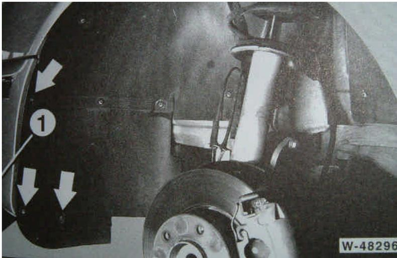
Die Spreizclips fuer Zierrgitter im Stossfaenger ausbauen, dazu Spreizstift -2- heraushebeln,
