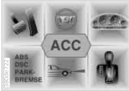
Die Aktive Geschwindigkeitsregelung ACC ist eine technisch fortschrittliche Weiterentwicklung der automatischen Geschwindigkeitsregelung. Eine gewählte Wunschgeschwindigkeit wird bei freier Fahrt selbsttätig gehalten. Im fließenden Kolonnenverkehr passt ACC die Geschwindigkeit an das vorausfahrende Fahrzeug an, sodass ein Mitschwimmen ohne ständiges Korrigieren der Geschwindigkeit durch den Fahrer ermöglicht wird.
